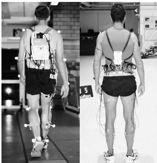
Abbildung 4 : Proband im Test, links. Rechts: Die Fortschritte der Messsysteme und Messmethoden ermöglichen es heute, mit mehr Markern und mehr EMG-Elektroden aber kleinerem Sender (für die Übertragung der EMG-Daten) zu arbeiten (Bachman et al., 2008).
