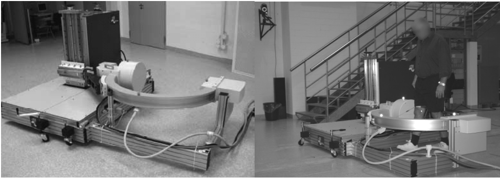
Abbildung 5: links: Moving-Fluoroskop, Bewegungsroboter mit C-Arm; rechts: Proband während einer Messung.
