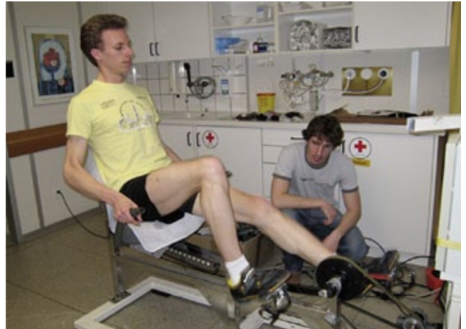
Abbildung 1: Versuchsanordnung in der ersten und dritten Teilstudie: Der Proband verrichtet sitzend mit den Beinen Bremsarbeit gegen einen 5PS-Elektromotor (dynamisch exzentrisch).
