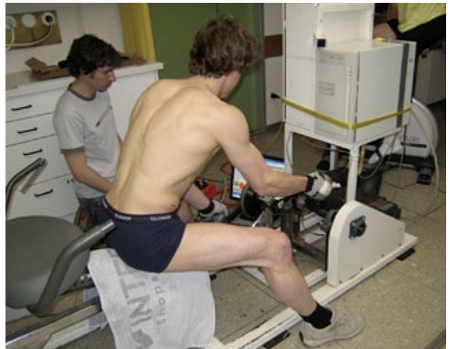
Abbildung 2: Versuchsanordnung in der zweiten Teilstudie: Der Proband verrichtet sitzend mit den Armen Bremsarbeit gegen einen 5PS-Elektromotor (dynamisch exzentrisch). Durch die Bremsaktivität der Arme wurde dabei die tiefe lumbale Rückenmuskulatur mit Extensions- und Rotations-Bremsarbeit belastet.
